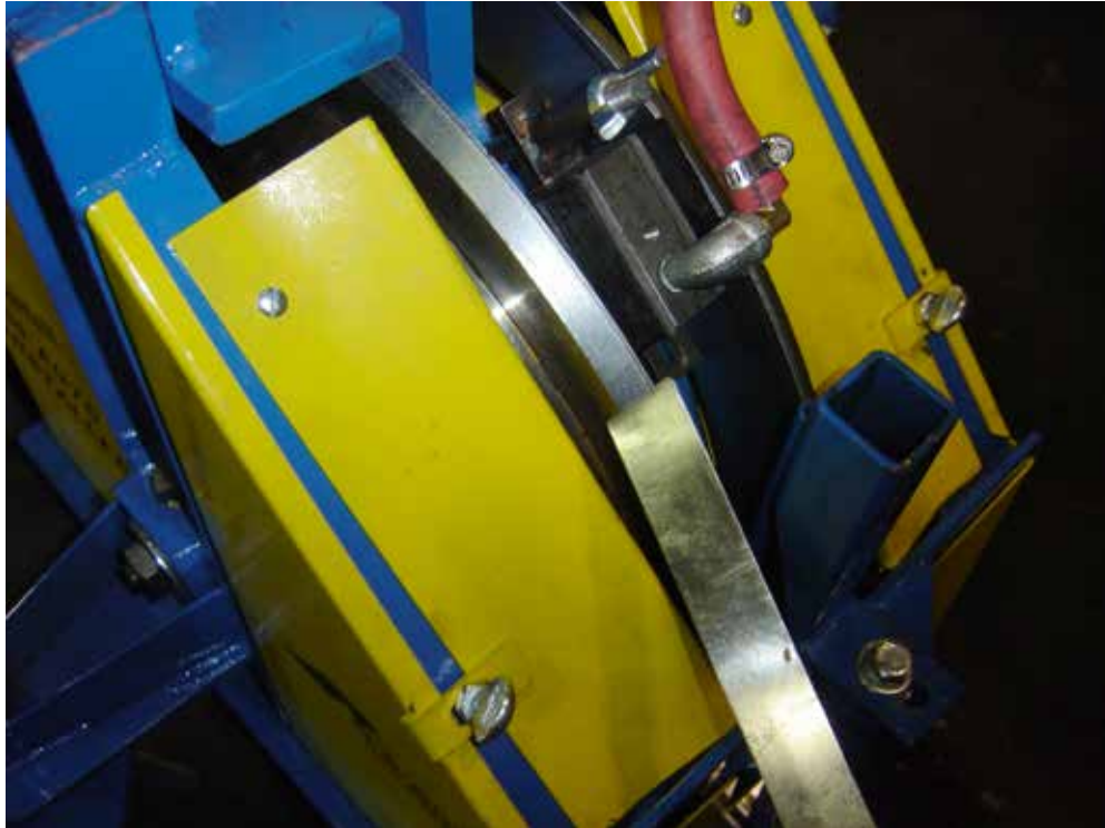
图 16 使用油灰刀清洁压缩叶片
