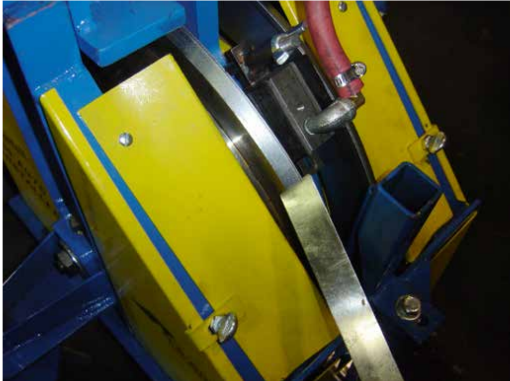
Figure 16 Nettoyage des lames de compression avec un couteau à mastic
