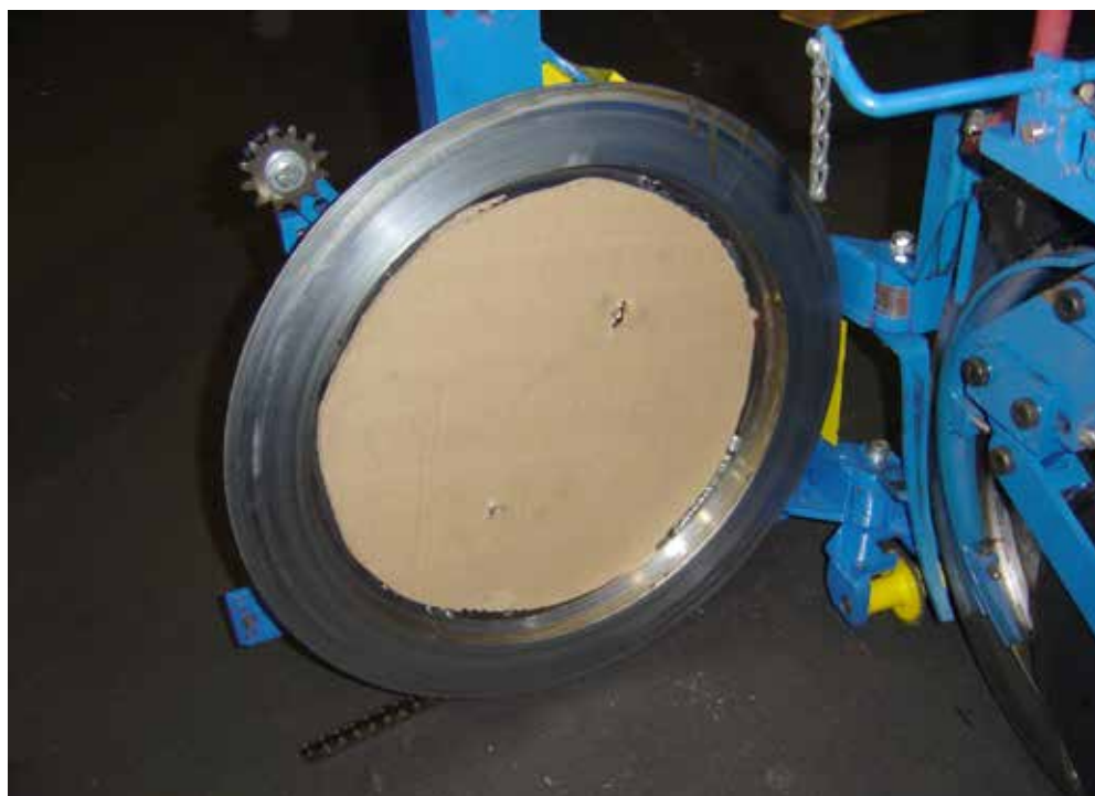
Figura 18 Coloque recortes de cartón dentro del álabes de compresión
