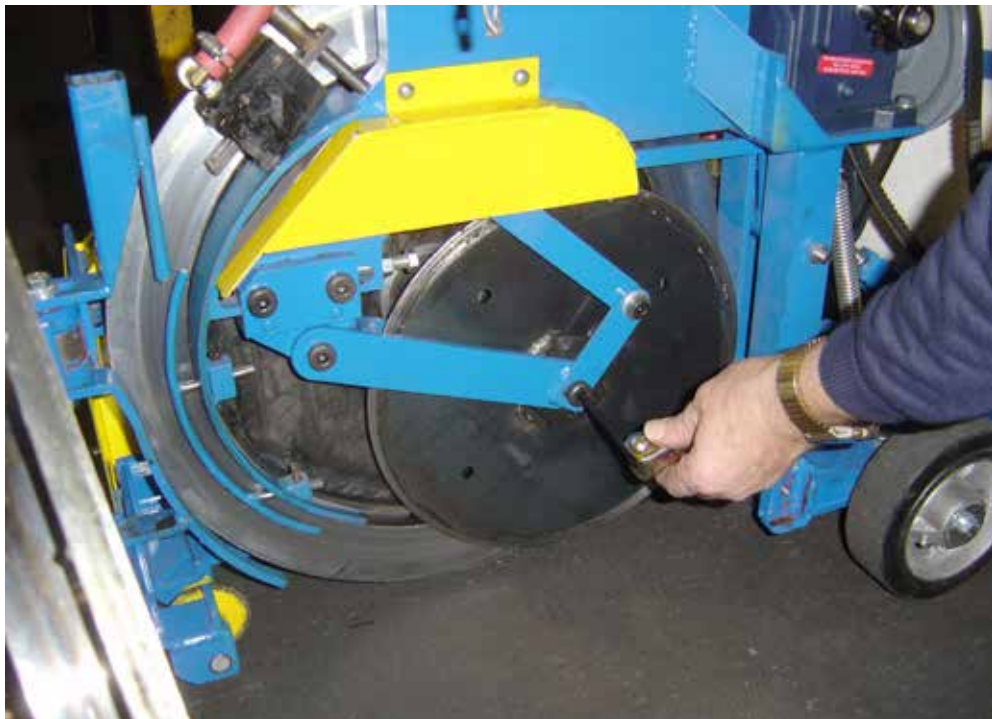
Figura 17 Retire el álabe de descarga para la limpieza
